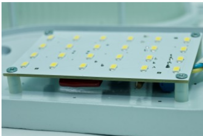
Монтаж модуля в корпус светильника с использованием винтов
